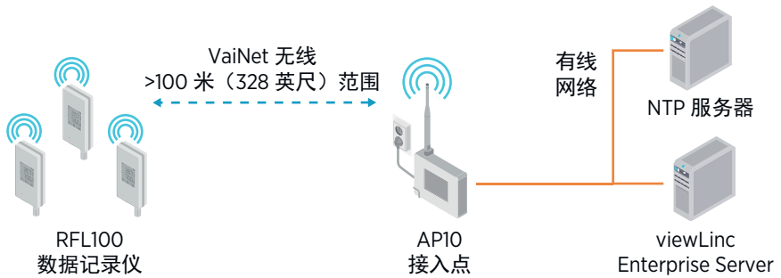
图 50 将 RFL100 连接到 viewLinc 监控系统
