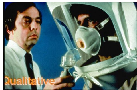
Bitrex fit test
