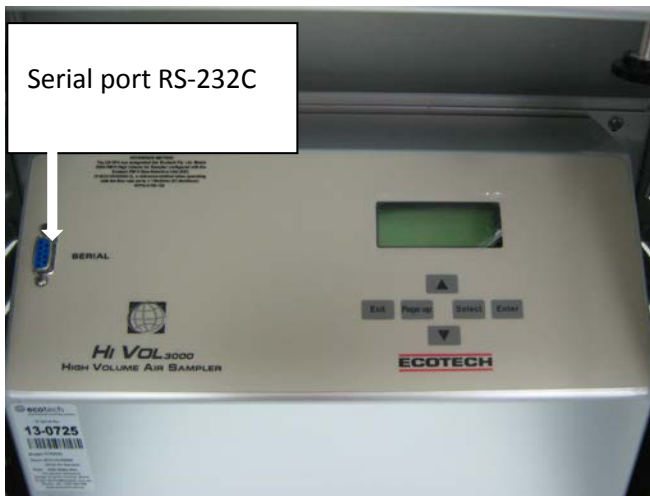
Figure 17– HiVol serial port (RS-232C)
