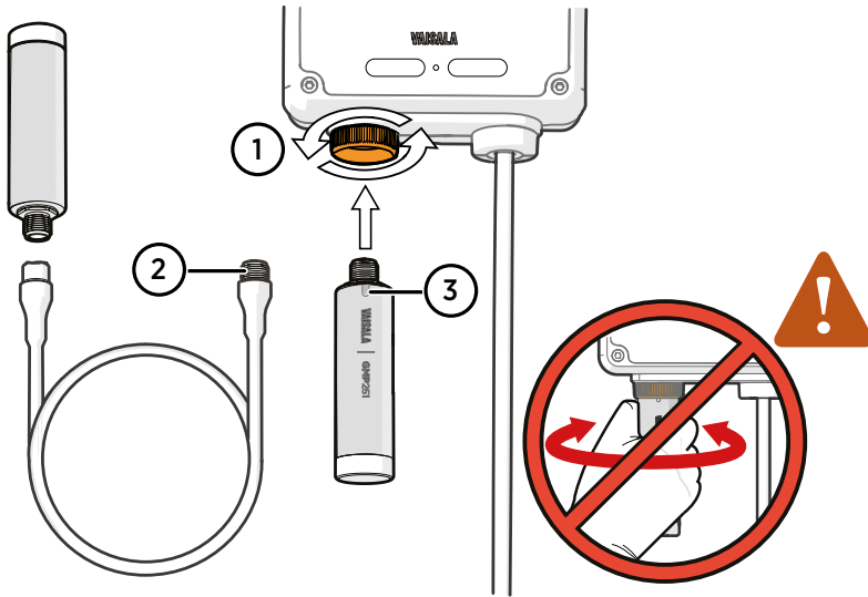
図 19 プローブとケーブルのIndigo200への取り付け
